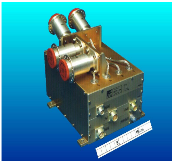
Obr. 3. Prístroj MEP1 umožňujúci flexibilné zmeny meracích režimov pre monitorovanie tokov nabitých častíc stredných energií na družici.
