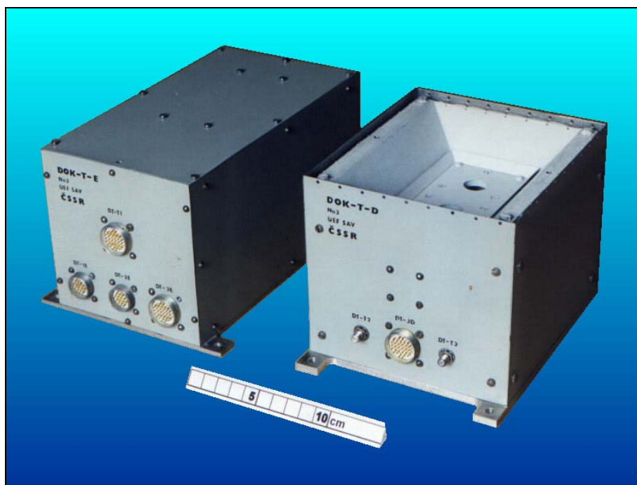
Spektrometer DOK-T bol prvým kozmickým prístrojom, od začiatku realizovaným priamo na pôde novovzniknutej vývojovo-realizačnej skupiny kozmickej techniky v roku 1974. Zároveň bol prvým prístrojom, ktorý využíval pasívne chladenie polovodičových detektorov na elimináciu ich šumu
