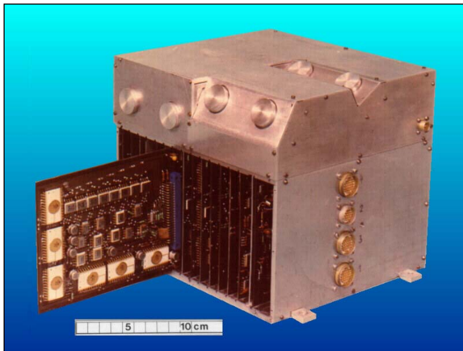
Spektrometer SPE-1 so šiestimi detektormi chladenými Peltierovými článkami sa podieľal na monitorovaní časticových tokov v rámci projektu ACTIVE a na orbite spoľahlivo pracoval po dobu 5 rokov
