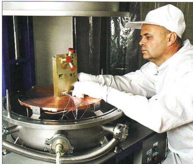
Ing. Ján Baláž, PhD., z ÚEF SAV pri vákuových testoch aparatúry PEEL pre raketu, ktorú vypustia koncom roka v Nórsku. Prístroj bude sledovať vysypávanie elektrónov do zemskej atmosféry.
