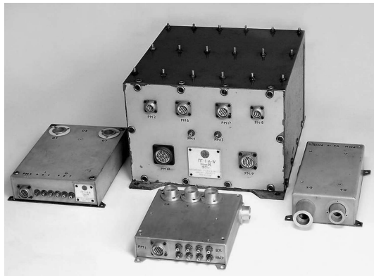
Obr. 1. Aparatura PG-1 vyvinutá na MFF UK v Praze pro IK-13. Měření byla využita např. pro studium krátkodobých variací toku částic v magnetosféře na malých výškách.
