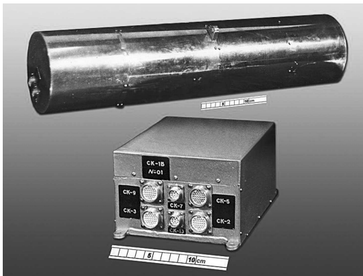
Obr. 2. Přístroj s označením SK-1. První přístroj, jehož část byla vyvinuta v Košicích a který měřil v kosmu neutrony a gama záření na nízké polární orbitě (IK-17). Detekční část byla vyvinuta ve Fyzikálně-technickém ústavu v Leningradě. Družice byla vypuštěna v září 1977.
