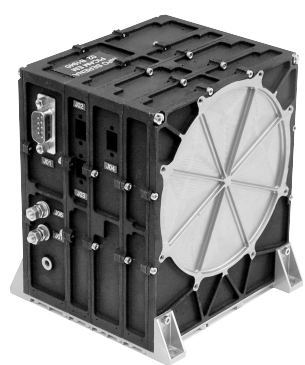
Elektronický box planetárnej iónovej kamery PICAM, ktorým košické pracovisko prispieva k misii ESA-BepiColombo na planétu Merkúr
