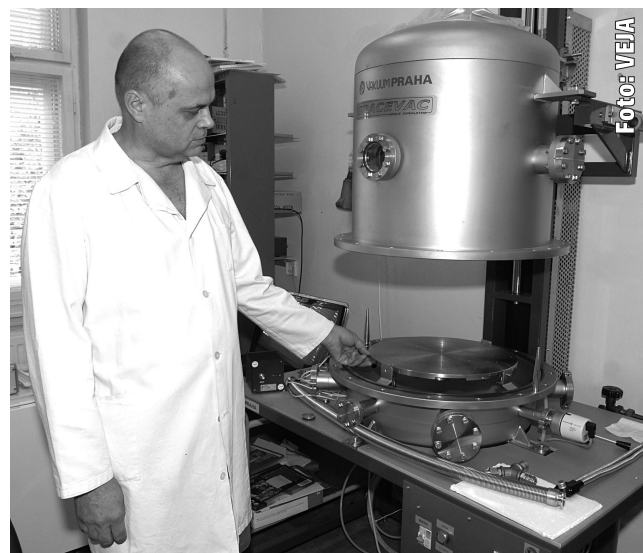
Ján Baláž pri simulátore kozmického prostredia SPACEVAC, ktorý slúži na termo-vákuové testy kozmických prístrojov
