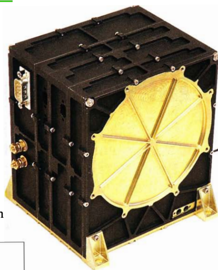
Prvým na Slovensku vyrobeným prototypom je PICAM-STM ( structural thermal model ), ktorý slúži na teplotné a mechanické testy, foto ÚEF, STIL
