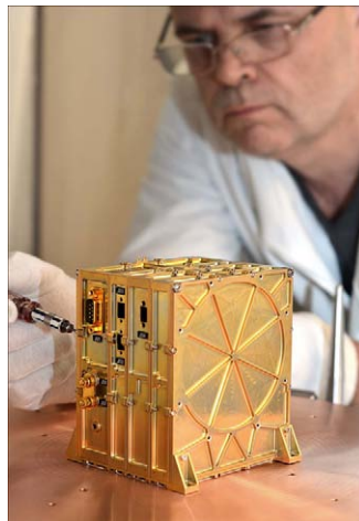
PICAM-FM ( flight model ). Letový elektronický box pred dokončením v ÚEF SAV. Až tento, v poradí piaty vyrobený, exemplár poletí k Merkúru. Foto ÚEF, STIL
