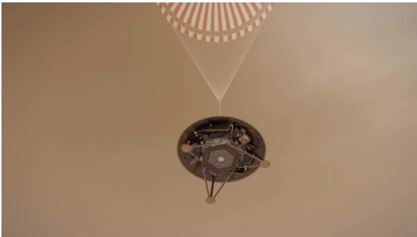
Zostupovať bude aj pomocou padáka, náraz majú tlmiť tri nohy. Zdroj – NASA
