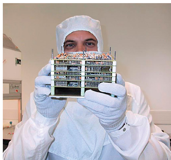
Obr. 7 Práce na ESS procesore v laboratóriách STIL za veľmi prísnej technologickej disciplíny a pod dohľadom inšpektorov ESA. Všetky komponenty, technologické postupy, operátori a pracovné priestory museli získať certifikát ESA na realizáciu tohto kritického systému. Zdroj: autor
