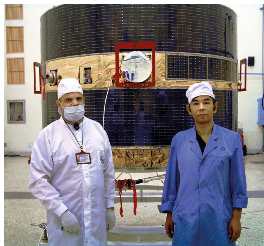
Obr. 4 Testy vedeckého nákladu satelitu TC-2 na čínskom kozmodróme Tai-Yuan krátko pred štartom. Uprostred senzor NUADU pokrytý optickým solárnym reflektorom. Zdroj: autor
