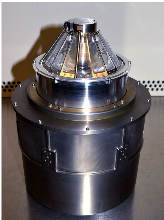
Obr. 15 Dokončený senzorový systém JDC aparatury PEP pre sondu JUICE. Zdroj: IRF
